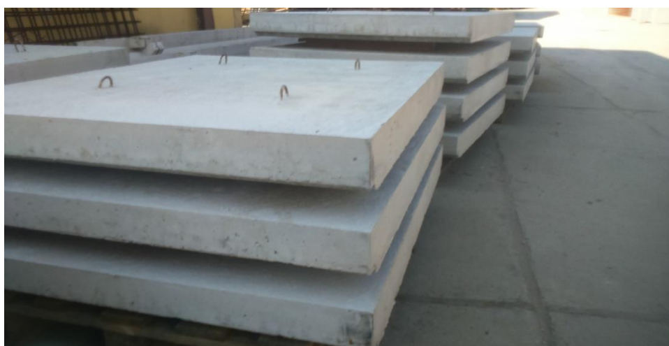
Zdj. Koryto kanału , pokrywa kanału
